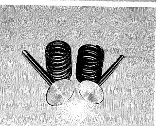
1600cc用ビックバルブ&バルブスプリング。右側が排気バルブ、左側吸気バルブ。価格は排気吸気バルブともに300フラン。ノーマルは排気側54フラン、吸気側49フラン。メカバーツの話ではA110はあまり高回転で使用しないのでダブルになっているスプリングは必要はないとのこと。ちなみに、フランス語の発音は排気がエシャップメン、吸気がアドミシオン。
