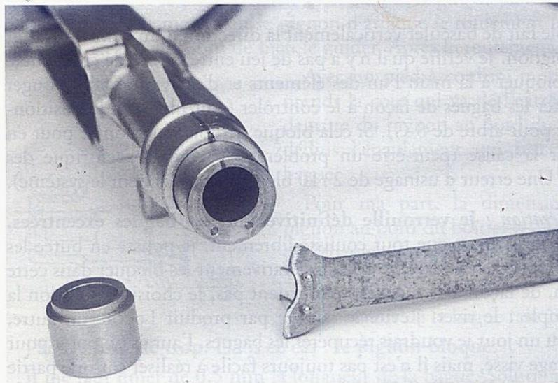
Je passe aux bagues. Après avoir défini la partie la plus fine, je présente ma clé sans ses rivets pour déterminer la position de mes trous. Je perce mon premier trou (diamètre 3 mm) dans la partie de la bague la plus épaisse. Je représente ma clé avec cette fois un rivet et je perce le second en me servant de mon outil comme gabarit.
